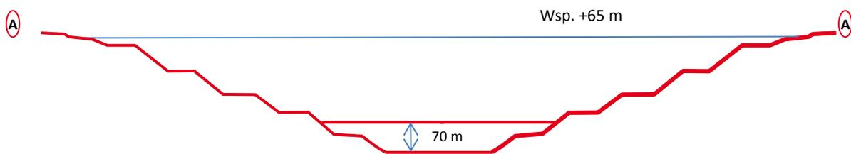
Abbildung 9 Schematischer Schnitt A-A durch den Tagebau
