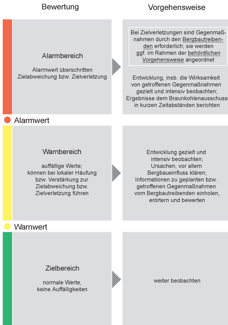
Abbildung 4 Integriertes System zur Bewertung und Vorgehensweise im Rahmen des Monitorings Garzweiler II
