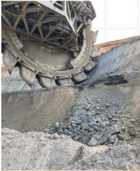
Gewinnung von standfestem M2-Material im Anschnitt
