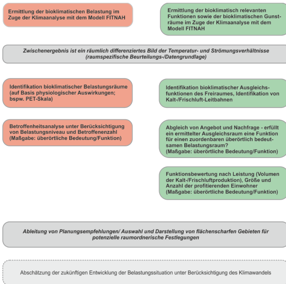
Abbildung A 1: Schematische Darstellung der übergeordneten Arbeitsschritte zur Ableitung von klimabezogenen Planungsempfehlungen für die Regionalplanung in Anlehnung an das „Referenzverfahren“ gem. dem „Methodenhandbuch regionale Klimafolgenbewertung“ (Hrsg. BMVBS 2013)
