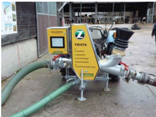
Abb. 9: Trista Andockstation mit NIR-Sensortechnik beim ersten Testeinsatz auf Haus Düsse
